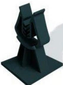
استحکام بالا با قابلیت تحمل بار نقطه ای (تا ۱۵۰ کیلوگرم) موارد کاربرد و میزان مصرف : در سازه هایی با وزن متوسط مانند تیرها، پوتروها و کف سازی های نیمه سنگین که قطر میلگرد آنها ۱۰ الی ۲۰ میلی متر می باشد مورد استفاده قرار می گیرد . میزان مصرف در کف های متوسط و نیمه سنگین ۴ عدد در هر مترمربع از واحد سطح و در تیرها و پوتروها ۳ عدد در هر مترطول می باشد .
