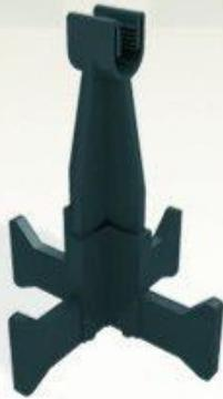
مقاومت عالی و تحمل بار نقطه ای (تا ۳۰۰ کیلوگرم) موارد کاربرد و میزان مصرف : در دال های بتونی و کف های دومش مورد استفاده قرار میگیرد که این قطعه به صورت دو تکه (نری و مادگی) طراحی شده که قسمت مادگی با پایه پوشش ۳۰-۲۵ میلیمتری ایجاد می کند و نری آن هم در سایزهای ۹۰ الی ۱۵۰ میلیمتر طراحی شده و انتخاب آنها بر اساس ضخامت سقف صورت می گیرد و میزان استفاده از این اسپیسر ۴ عدد در هر مترمربع از واحد سطح می باشد .
